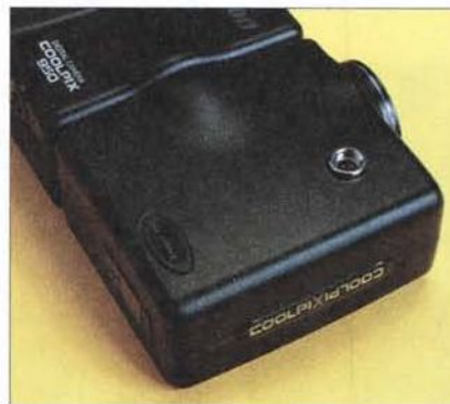
L'ingresso per l'alimentatore esterno, l'uscita video PAL, l'alloggiamento per la Compact Flash (8MB standard). A destra, sul fondo della macchina, la regolazione diottrica del mirino e il contatto (proprietario) per il flash TTL esterno.
